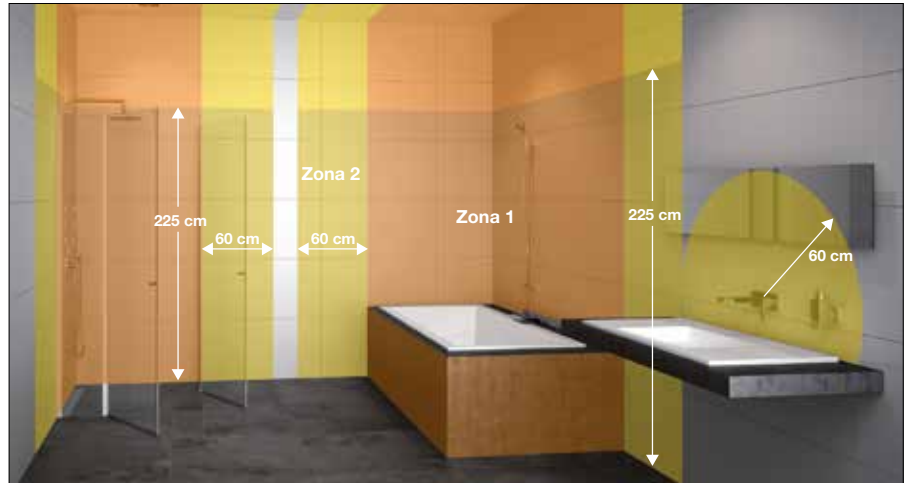
Ejemplo: Asignación de las zonas de protección en los baños según la norma DIN VDE 0100-701
